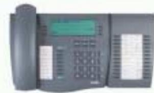
Динамическое присвоение IP-адресов (по протоколу DHCP), наличие дополнительного Ethernet-порта, механизм гибкого распределения битов TOS и определения класса обслуживания (CoS) уровня 2 (IEEE 802.1 p/Q и VLAN Id) являются отличительными особенностями современного IP-телефона.
